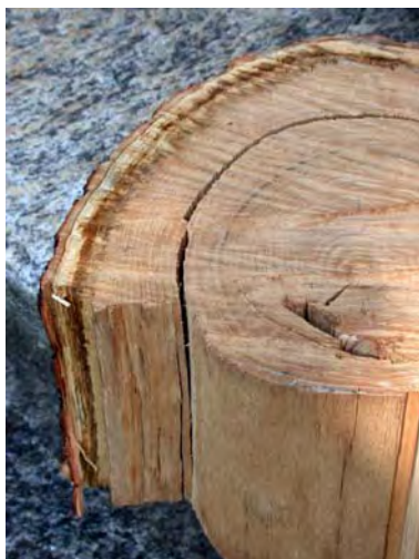
Abbildungen 2a/b/c: Stammquerschnitte im Vergleich: mit typischer Ringschäle (links+mitte), Ringschäle-freies Holz mit radialem Herzriss (rechts) (Fotos: P.Fonti, WSL).
