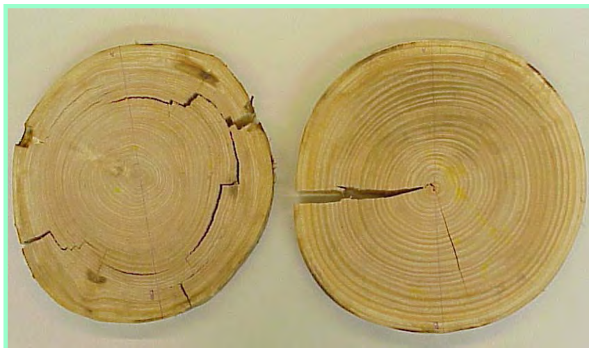
Abbildungen 2a/b/c: Stammquerschnitte im Vergleich: mit typischer Ringschäle (links+mitte), Ringschäle-freies Holz mit radialem Herzriss (rechts) (Fotos: P.Fonti, WSL).
